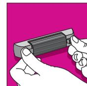
KabelClip auf die vorgesehene Position setzen, kurz anpressen
